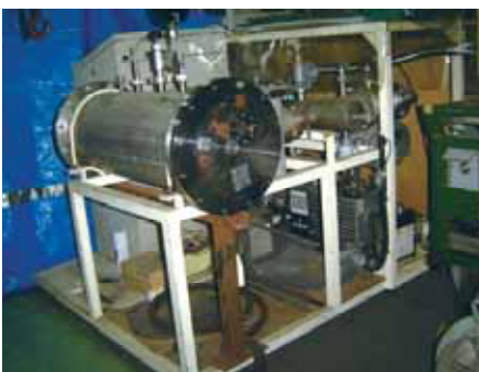
写真2 真空ポンプと減圧試験容器
