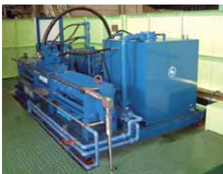
写真1 水圧サイクル試験用高圧ポンプ
