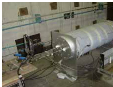
写真4 円筒型加熱炉
