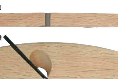
図2 曲面を削る鉋による削り面形状
