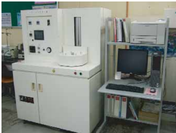
写真1 変態点測定装置 (アルバック理工(株) 機器名称:トランスマスターII)
