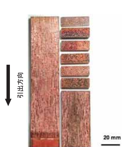
図5 連続鋳造法で作製されたロータス鋼。作製条件:水素雰囲気ガス圧力1.0MPa、引出速度 10mm min -1 (右上部はロータス鋼の断面を示した)
