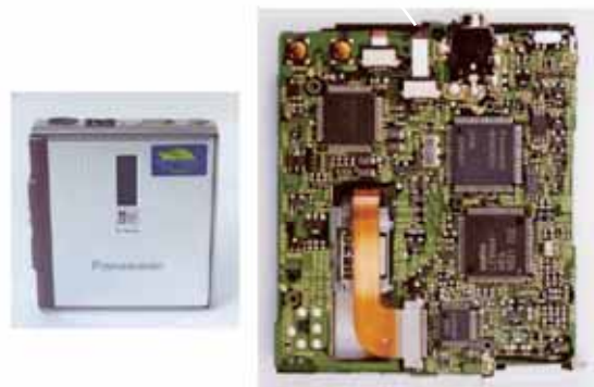
写真1 Sn-Ag-In-Bi系で1998年にリフロー量産を果たしたMDとその実装基板(パナソニック)
