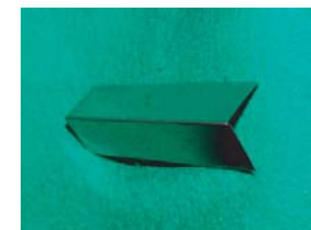
図7 極薄箔(100μm厚)の溶接例
