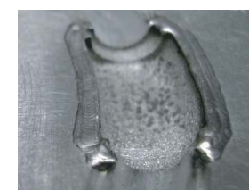
図8 レーザによる補修溶接
