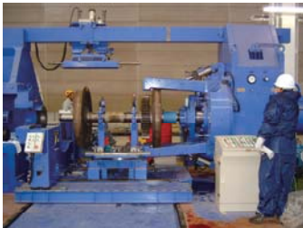
写真1 輪軸着脱装置による輪軸分解
