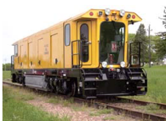
写真2 レール削正車
