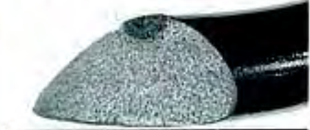
【写真3】応力集中部より破損した軸の破面状況(片側平面曲げ)
