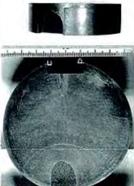
【写真1】キー溝より破損した軸の破面状況(回転曲げ)
