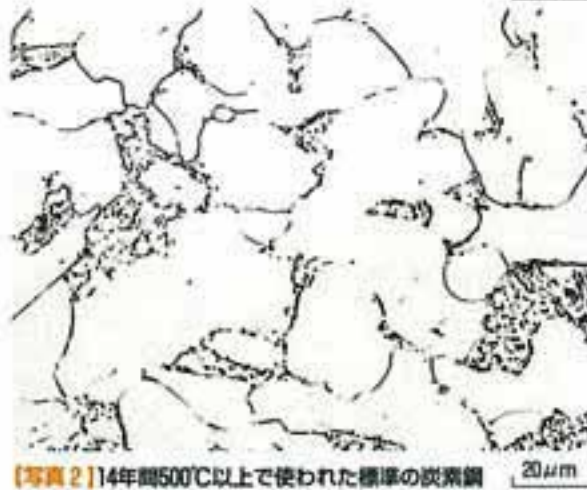
【写真2】14年間500°C以上で使われた標準の炭素鋼
