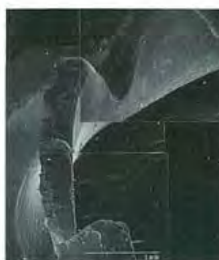
【写真4】おろし金(ステンレス製)の目(走査電子顕微鏡による)
