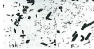
透過型電子顕微鏡による 析出物観察 (x10,000)2 1/4Cr-1Mo
