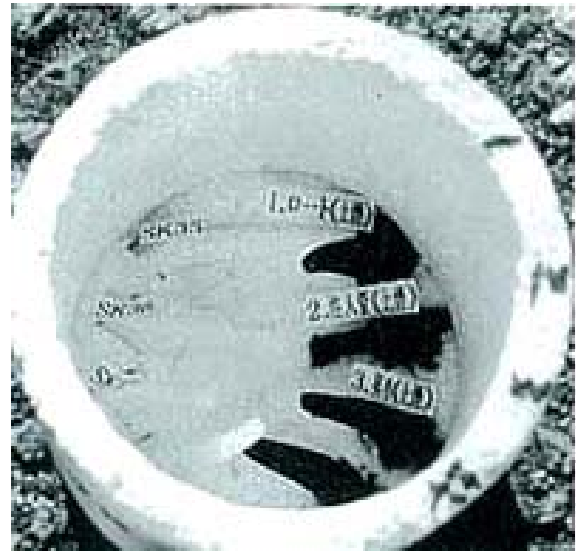
写真3 ゼーゲルコーンによる耐熱性の評価 標準コーンと試料コーンの溶倒状況 (白色：標準コーン、茶色：試料コーン)
