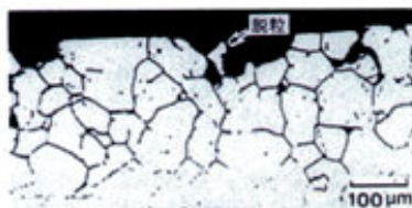
写真 1 鋭敏化した 304 鋼の粒界腐食 (沸騰 65%硝酸、144h)
